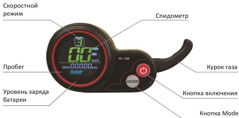
1. Параметр «Gear» показывает текущий скоростной режим. В значении «1» скорость самоката составит до 10–15 км/ч, в значении «2» — до 25 км/ч, в значении «3» — до максимальной скорости.
